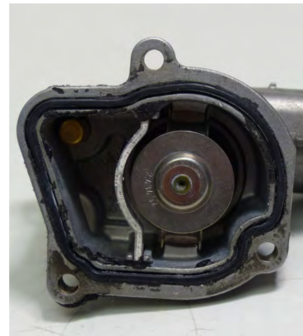
Fig. 1 Mastic d'étanchéité sur le boîtier du thermostat
