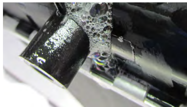
Fig. 2 Fissure sur la fixation
