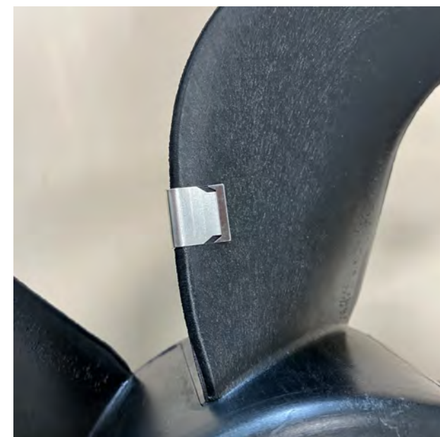
Fig. 1 Agrafes métalliques utilisées pour l'équilibrage
