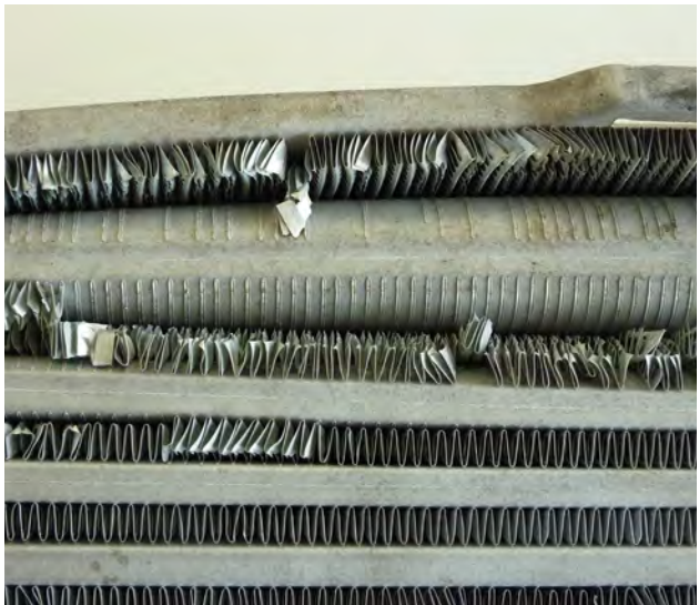
Fig. 3 Tuyau du radiateur gonflé
