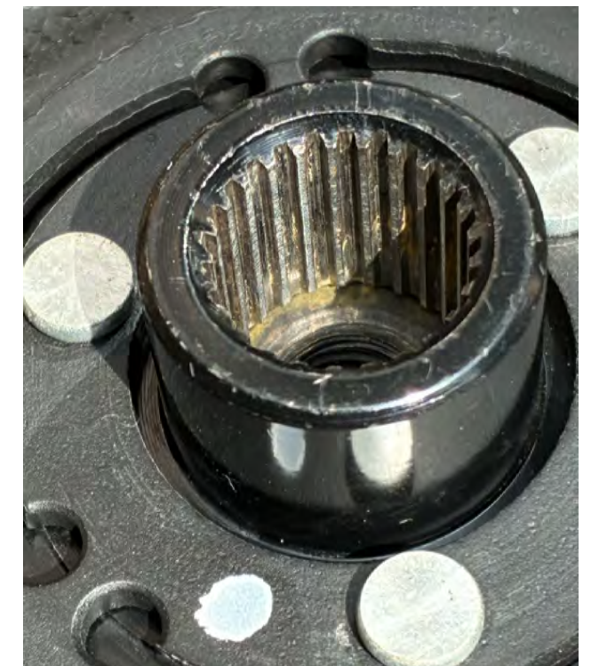
Fig. 4 Pour comparaison : engrenage neuf
