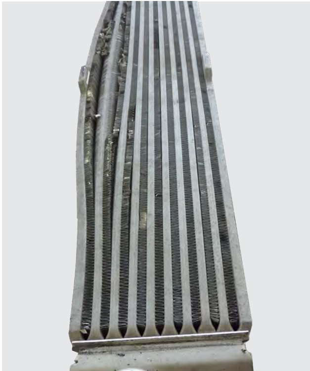
Fig. 2 Gonflement sur le refroidisseur d'air de suralimentation
