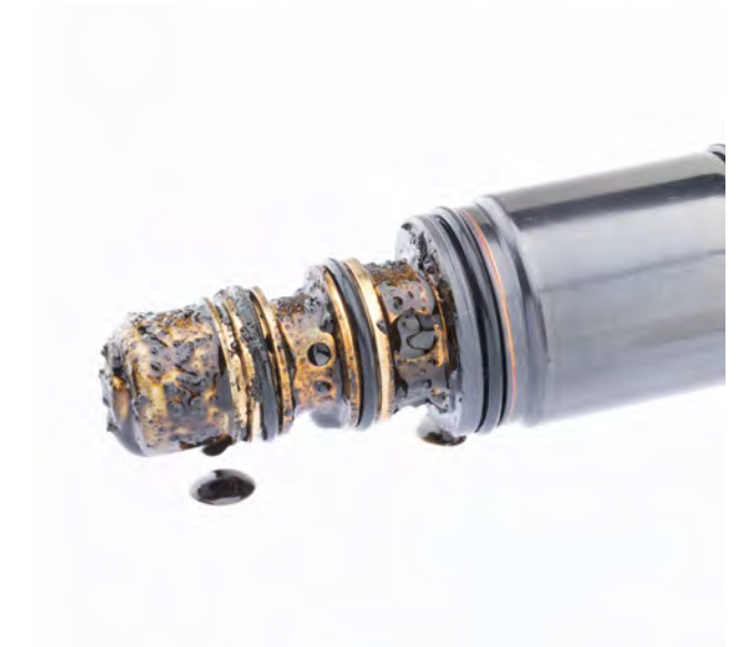
Fig. 4 Copeaux et huile noire sur l'électrovanne
