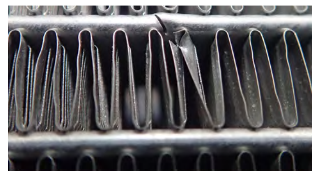
Fig. 3 Dommage mécanique (coupure)
