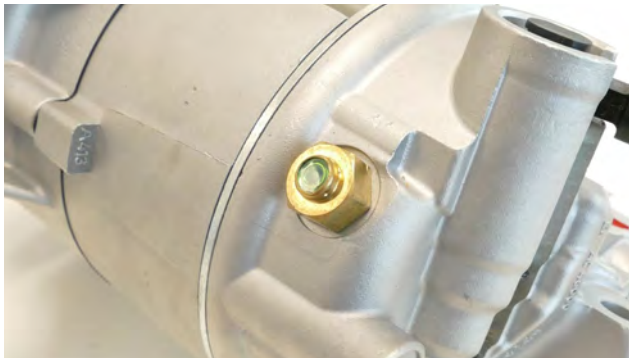
Fig. 2 Film protecteur donc limiteur non déclenché
