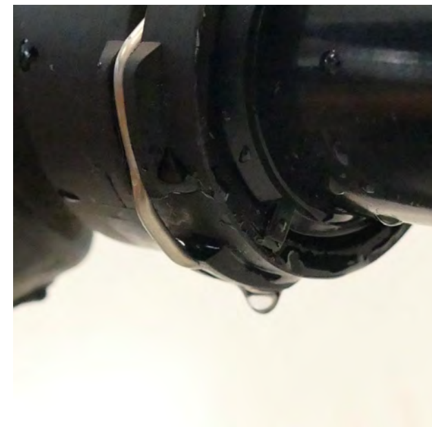
Fig. 1 Fuite sur le joint torique
