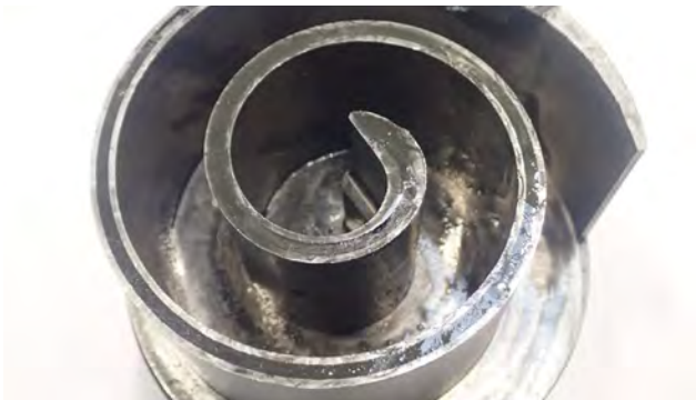
Fig. 1 Spirale fortement usée par le compresseur Scroll
