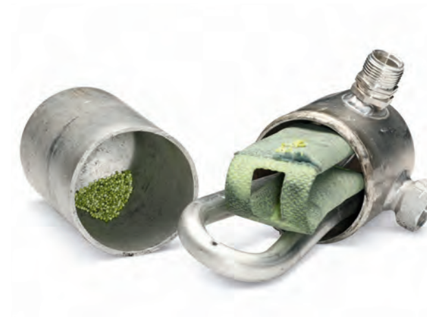
Fig. 1 Perte de granules sur la bouteille déshydratante
