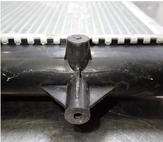
Fig. 2 Réservoir d'eau fissuré
