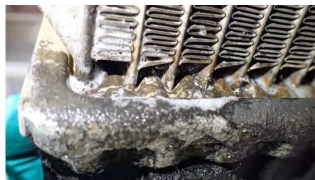
Fig. 4 Corrosion sur l'extérieur du radiateur
