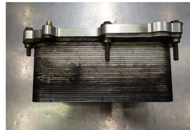
Fig. 1 Fuite du refroidisseur d'huile
