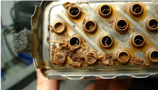
Fig. 2 Échangeur de chaleur obstrué
