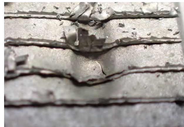
Fig. 2 Déformation et fissure
