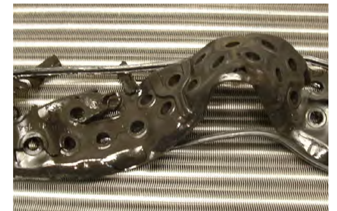
Fig. 1 Joint gonflé sorti du radiateur de refroidissement
