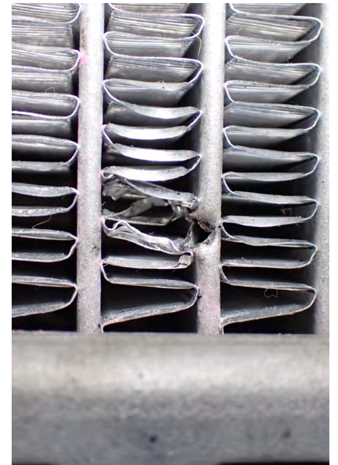
Fig. 3 Impact de gravillons
