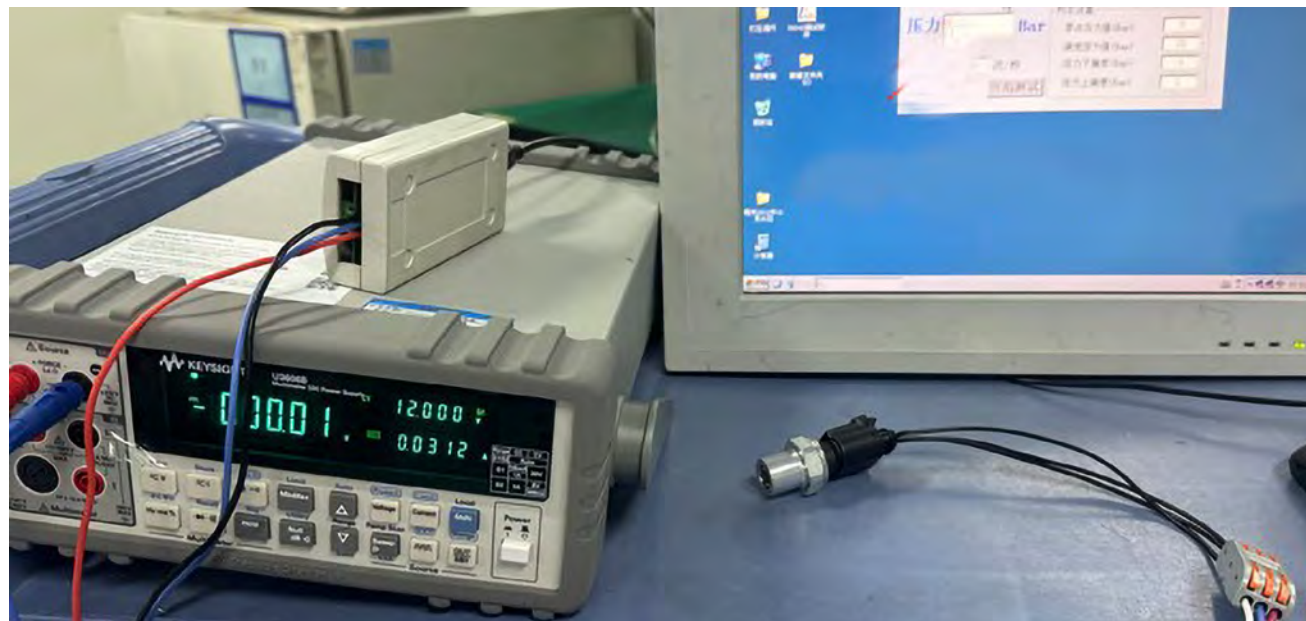
Fig. 4 Contrôle d'un pressostat en laboratoire
