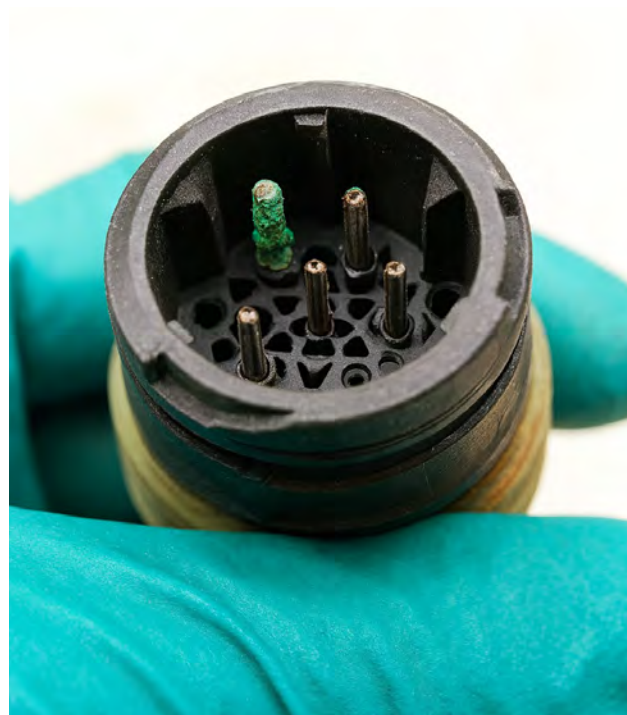
Fig. 1 Corrosion sur la prise
