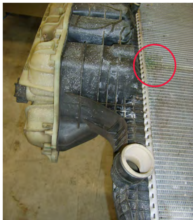
Fig. 1 Fuite apparente sur le radiateur
