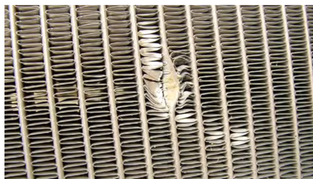
Fig. 3 Impact de gravillons sur le radiateur
