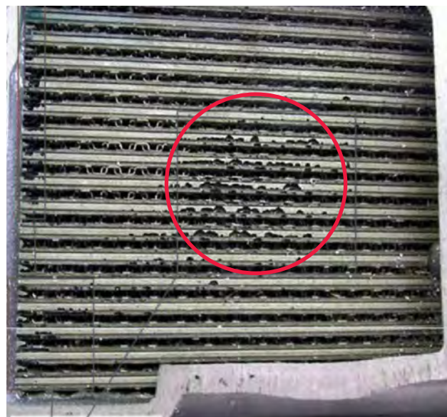
Fig. 1 Cavitation sur les tuyaux du refroidisseur d'huile
