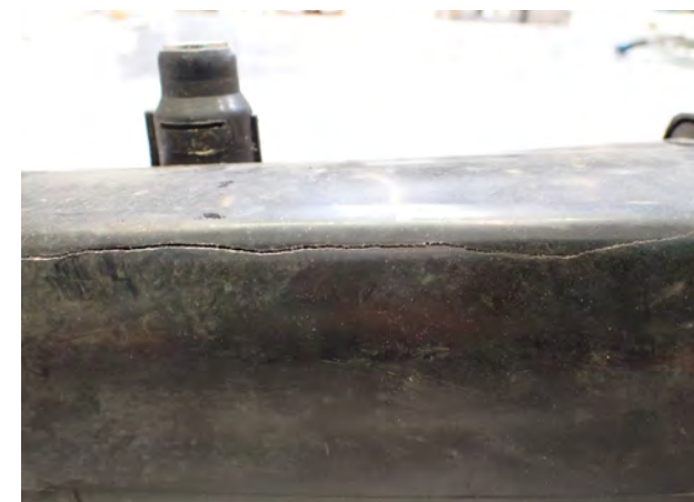
Fig. 1 Fissure dans le vase d'expansion
