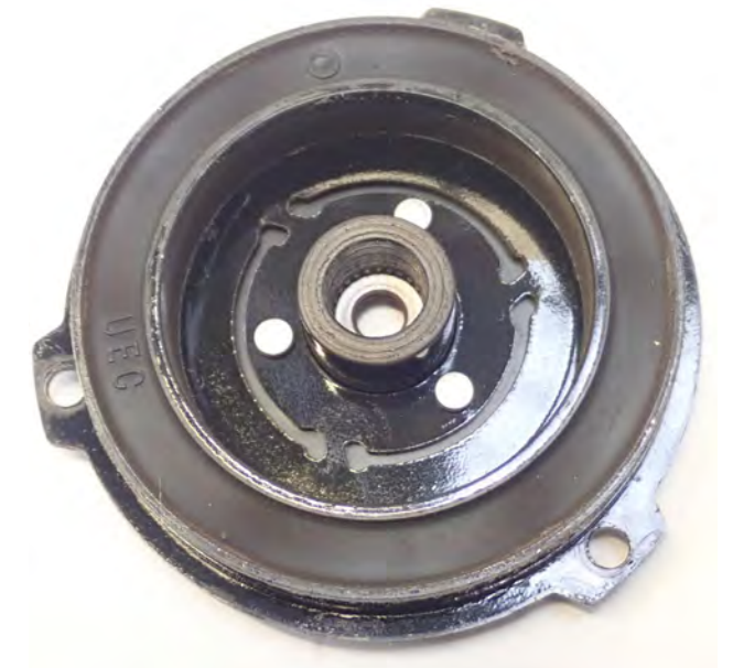
Fig. 2 Engrenage usé le moyeu
