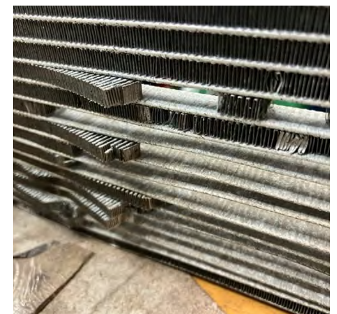
Fig. 2 Corrosion sur les ailettes de refroidissement
