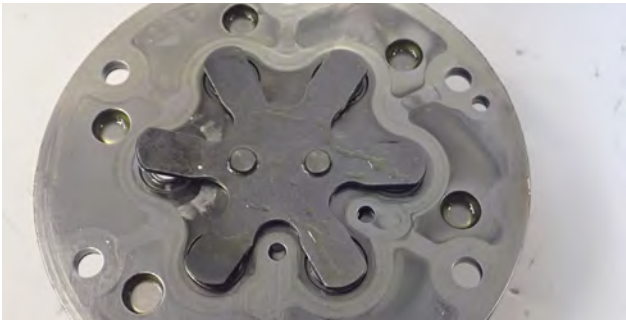
Fig. 2 Limite de la soupape HP déformée
