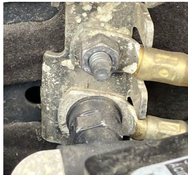
Fig. 2 Corrosion au point de masse
