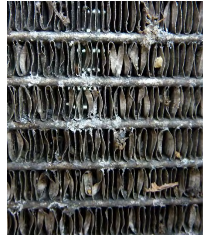
Fig. 2 Ailettes de refroidissement encrassées et déformées
