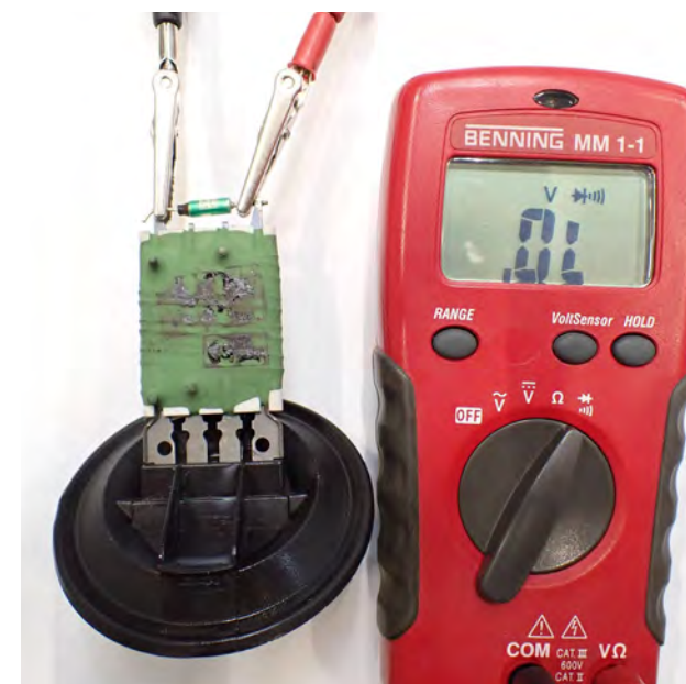
Fig. 1 Test du régulateur calciné
