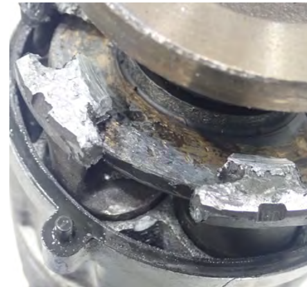
Fig. 3 Grippage sur le piston et le plateau oscillant
