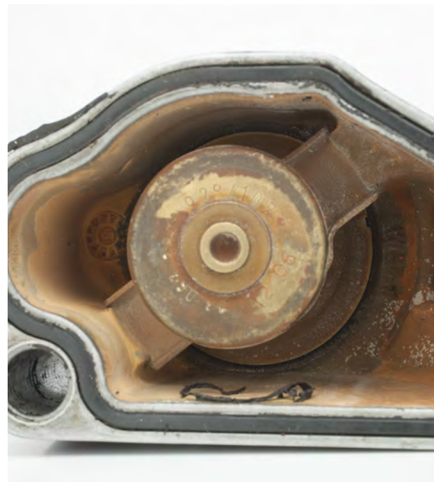
Fig. 2 Corrosion sur le thermostat
