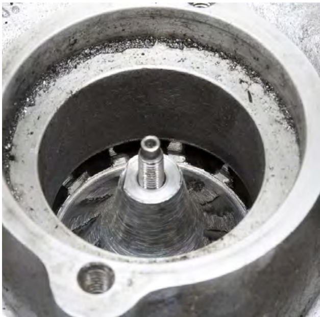
Fig. 2 Copeaux issus de dommages au turbocompresseur
