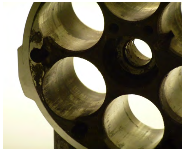
Fig. 2 Grippage sur le cylindre
