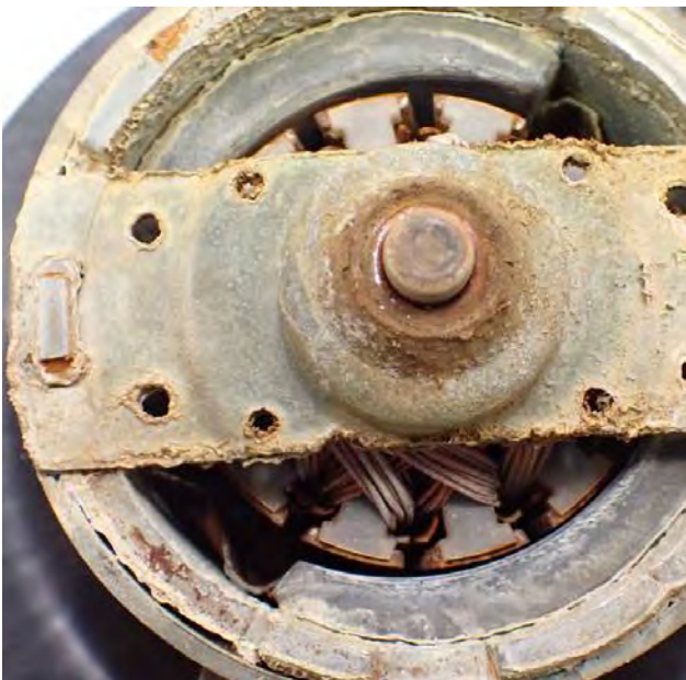
Fig. 1 Palier endommagé sur le moteur du ventilateur
