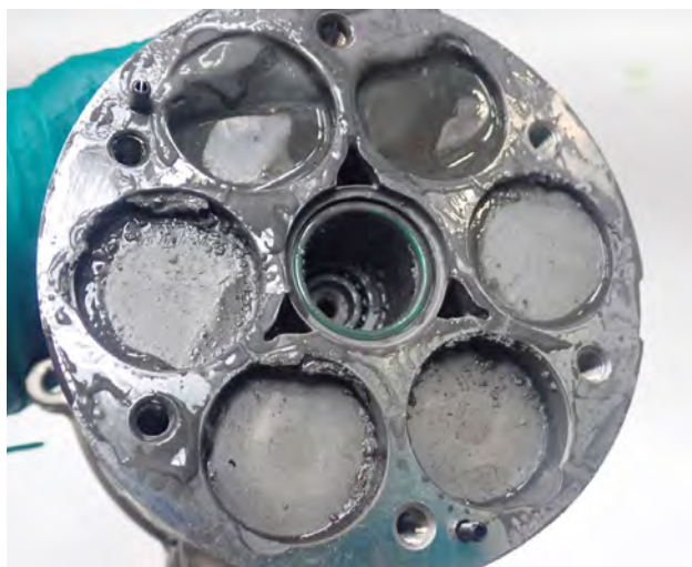
Fig. 1 Grippage important sur le piston et le cylindre
