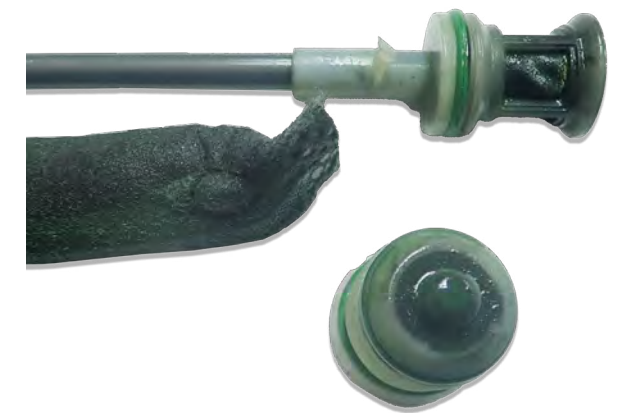
Fig. 2 Bouteille déshydratante obstruée
