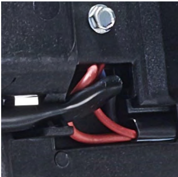
Fig. 2 Rupture de câble dans la commande du ventilateur
