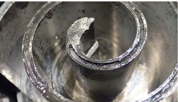
Fig. 2 Joint frontal sur la spirale détruit
