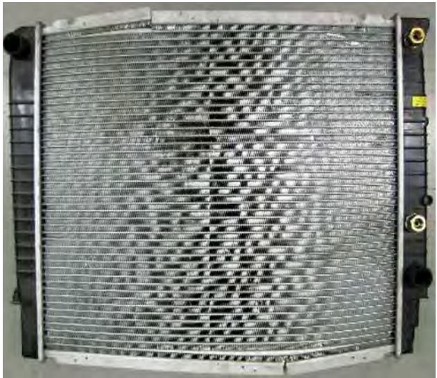
Fig. 1 Radiateur de refroidissement gonflé
