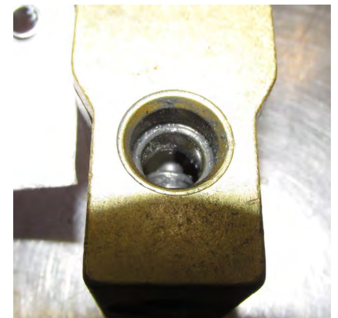
Fig. 2 Détendeur encrassé
