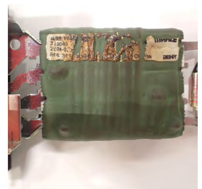
Fig. 2 Régulateur de pulseur surchargé thermiquement
