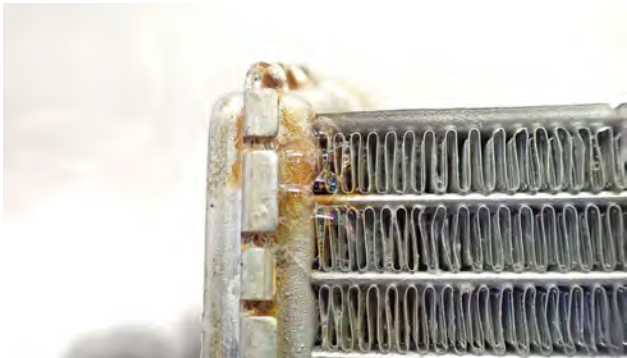
Fig. 4 Échangeur de chaleur rouillé
