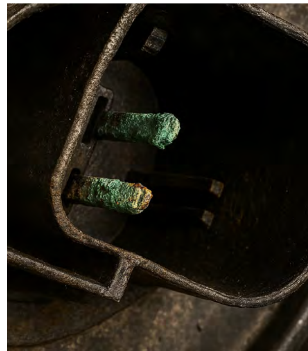
Fig. 2 Corrosion sur les connecteurs
