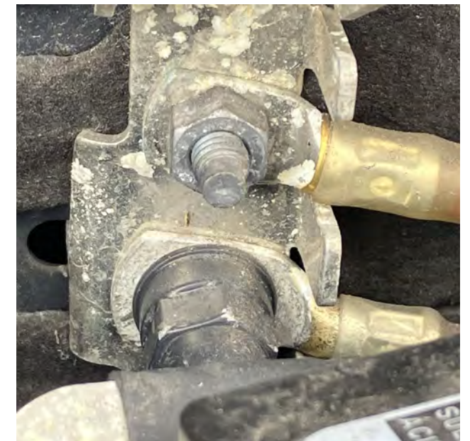
Fig. 2 Corrosion au point de masse
