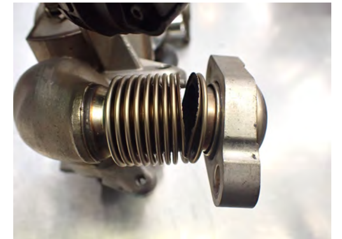
Fig. 2 Flexible arraché du refroidisseur EGR
