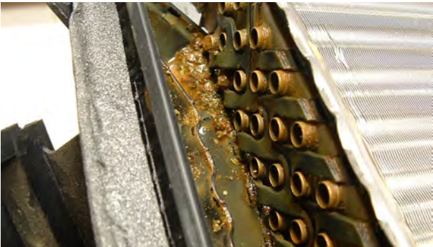
Fig. 3 Dépôts et impuretés dans l'échangeur de chaleur
