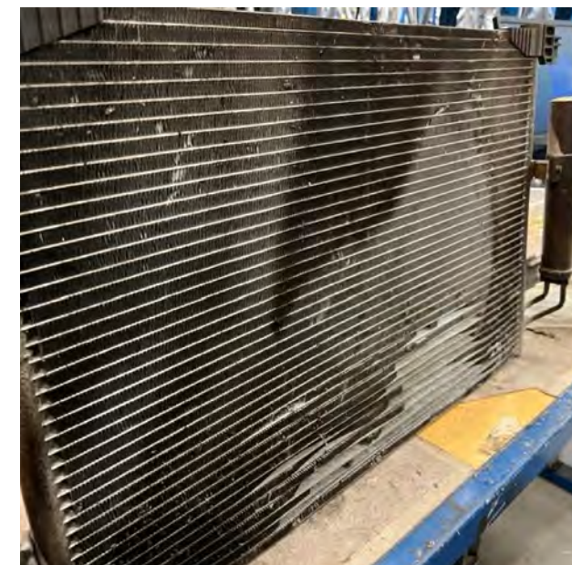
Fig. 1 Corrosion sur le condenseur
