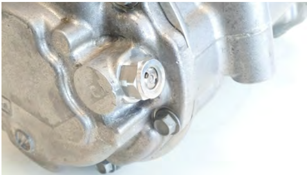
Fig. 1 Limiteur de pression déclenché
